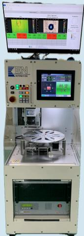
スポット溶接部全自動検査装置
